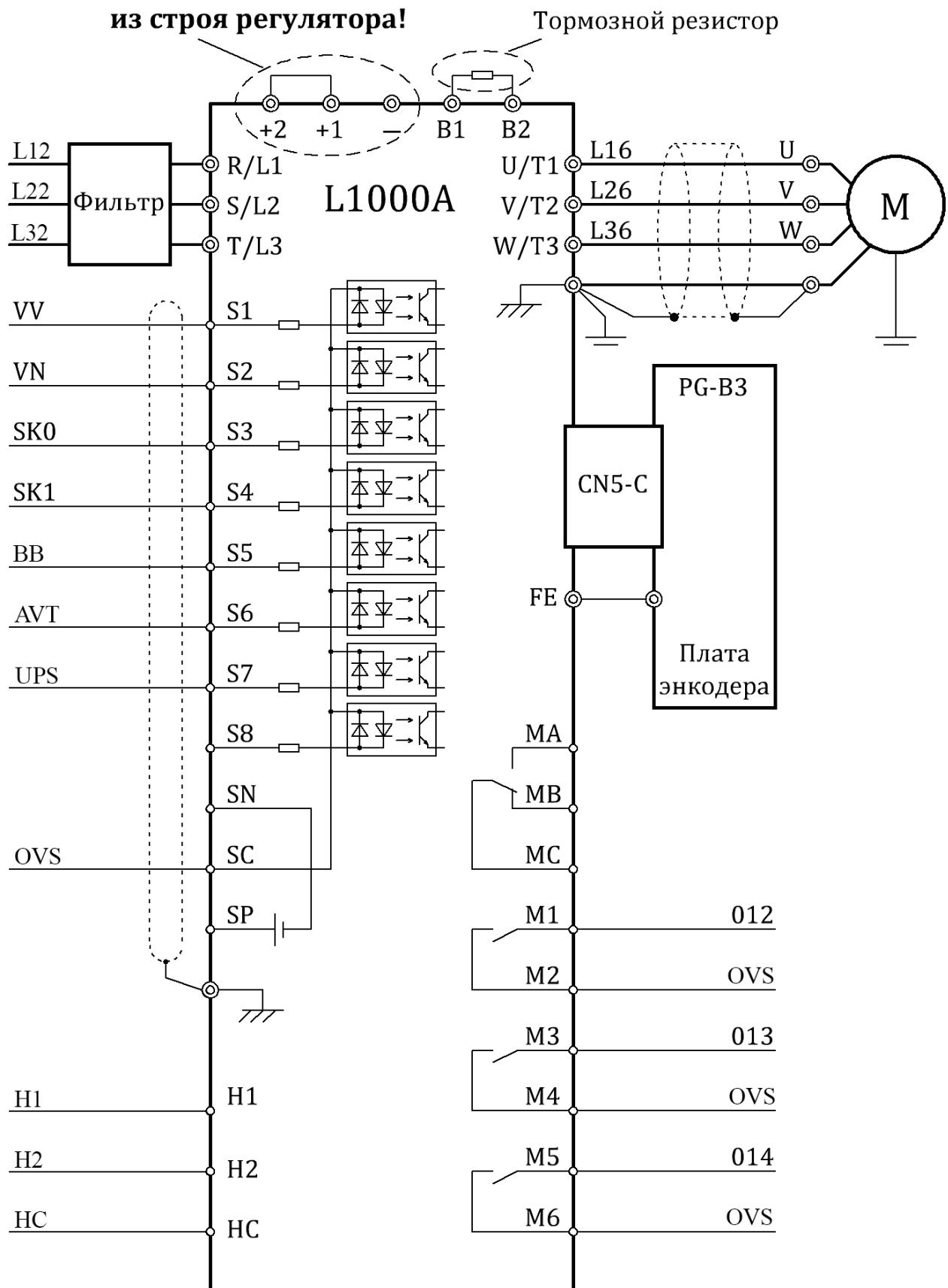
Рисунок 4.5 - Подключение к станции управления МЛК
