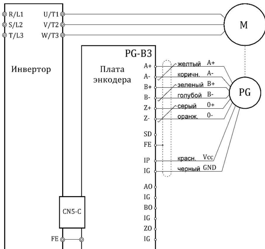
Рисунок 4.6 - Схема подключение энкодера HOHNER к плате PG - B3
