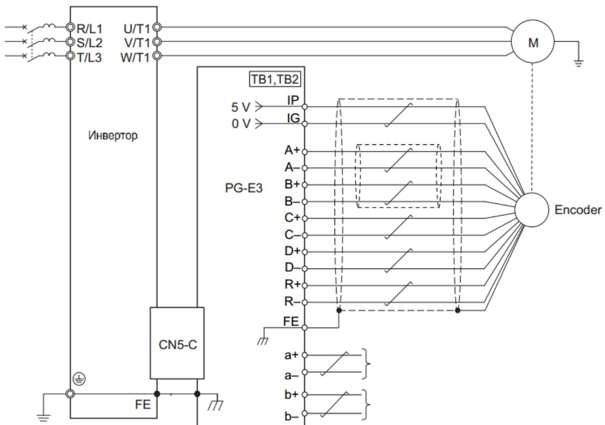
Рисунок 4.9 - Схема подключение энкодера к плате PG - E3
