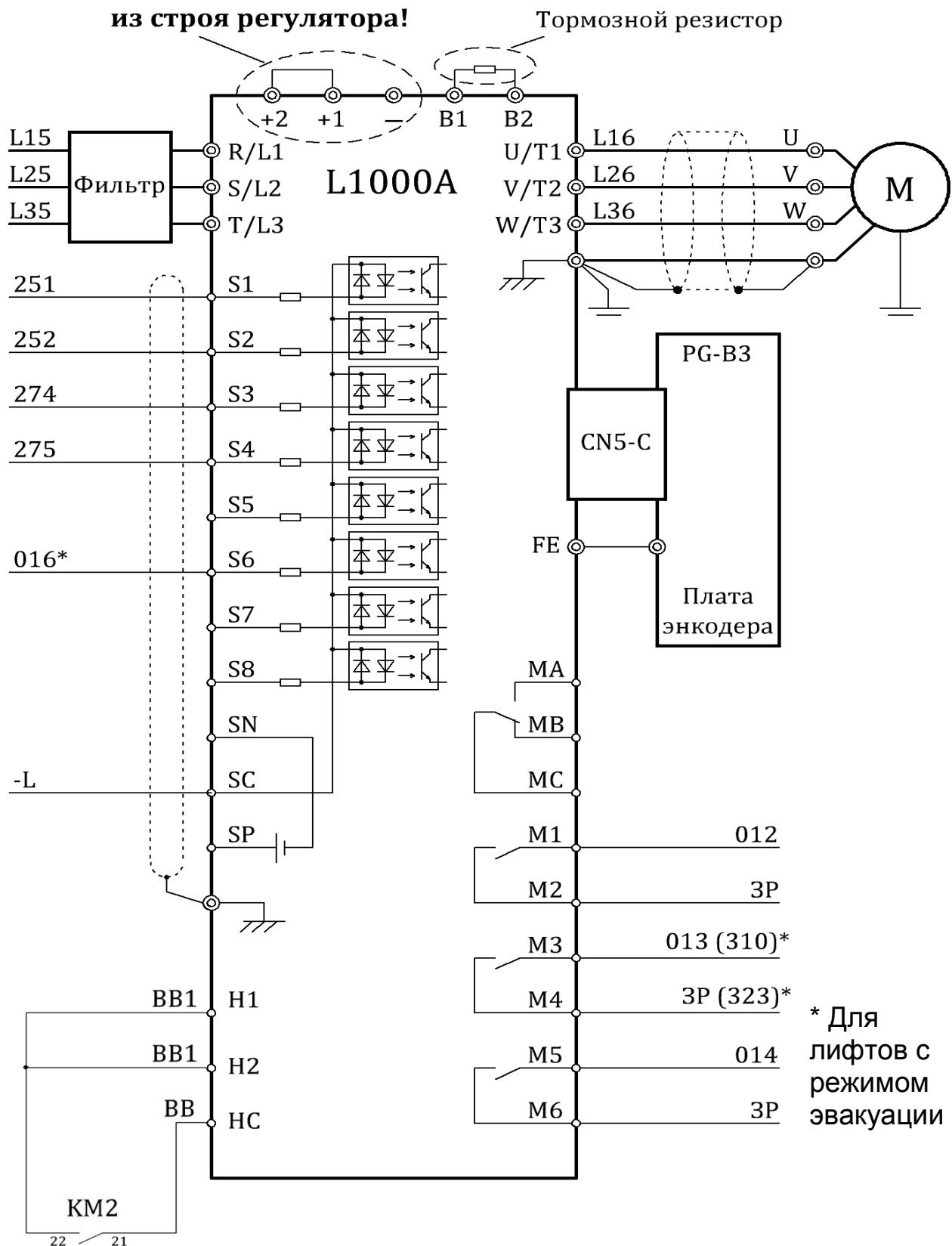
Рисунок 4.1 - Подключение к станции УЛ
