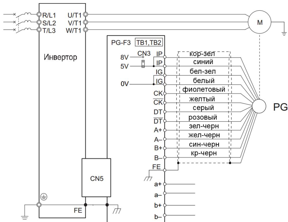
Рисунок 4.8 - Схема подключение энкодера к плате PG - F3
