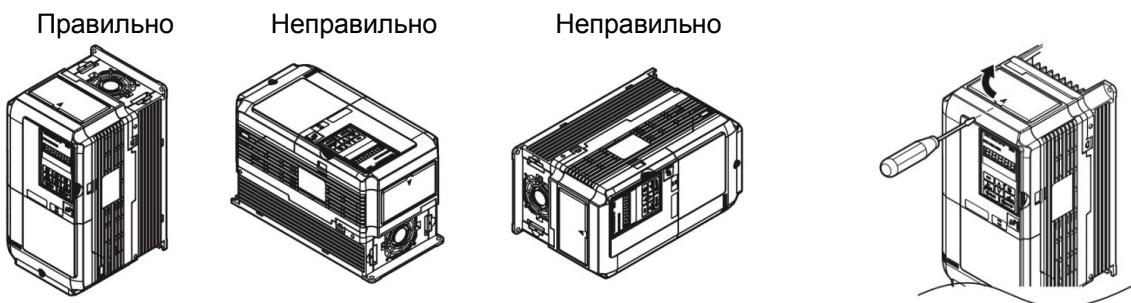
Рисунок 2.1 - Правильное расположение при монтаже
