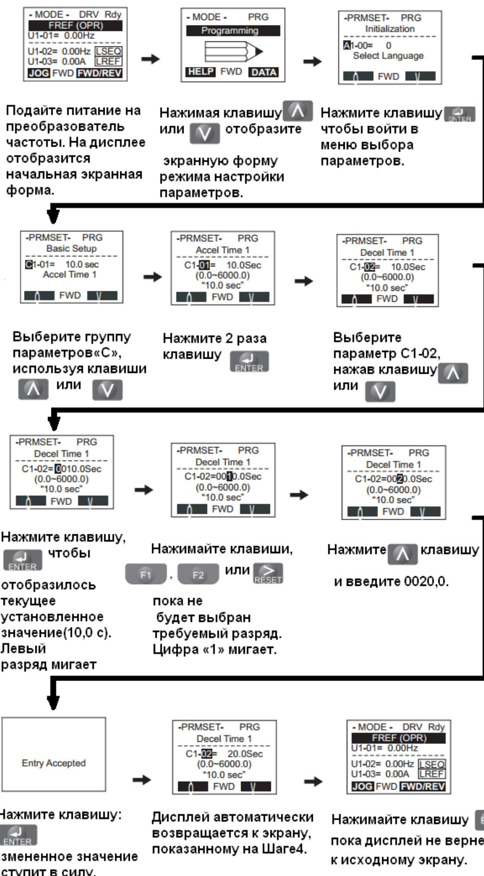
Рисунок 5.3- пример изменения параметра C1-02
