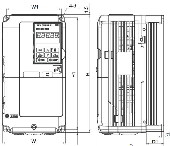
Рисунок 2.3- Размеры трехфазных приводов класса 400В
