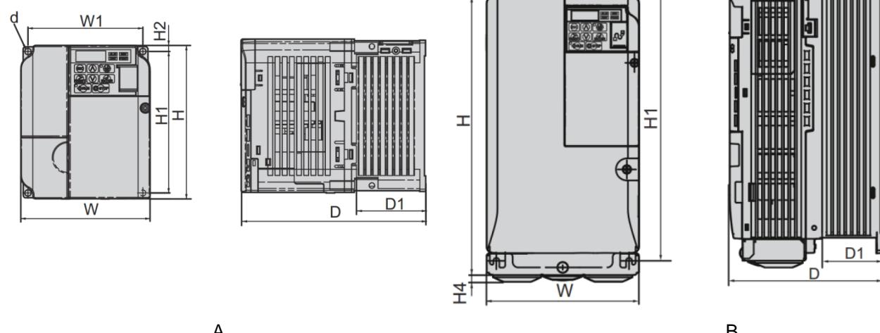
Рисунок 2.4- Размеры трехфазных приводов класса 400В
