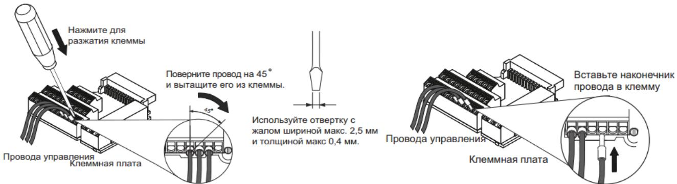
Рисунок 3.1 – Порядок подключения проводов к клеммам и извлечение проводов из клемм.
