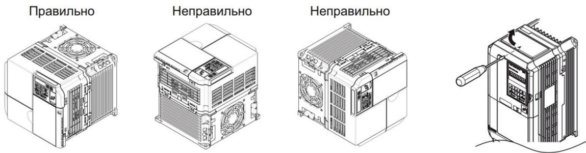
Рисунок 2.1 - Правильное расположение при монтаже
