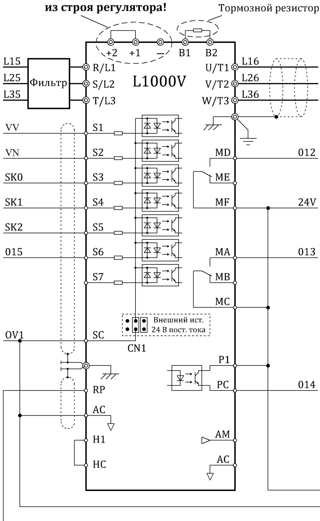
Рисунок 4.3 - Подключение к станции РСУЛ
