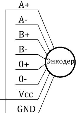
Рисунок 4.2 - Подключение к станции УКЛ
